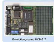
Der SAB 80C517A ist die ROM-lose Version des 80C517 aus der Familie der 8051-Prozessoren von Siemens. Es handelt sich um einen 8bit-Mikrocontroller mit einer maximalen Taktfrequenz von 12 MHz. Aufgrund einer umfangreichen Integration von Standardperipherie, des flexiblen Interruptsystems, der hohen Rechengeschwindigkeit und der verschiedenen Betriebsmodi bietet sich ein breites Spektrum von Anwendungsmöglichkeiten in der Prozessautomatisierung.
