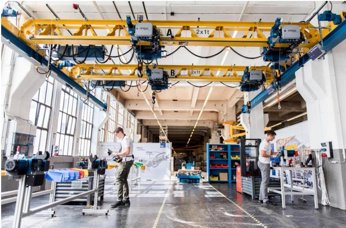
Verteilte Steuerung MHS mit zwei Kranen und 4 Katzen (Quelle: DEMAG)
