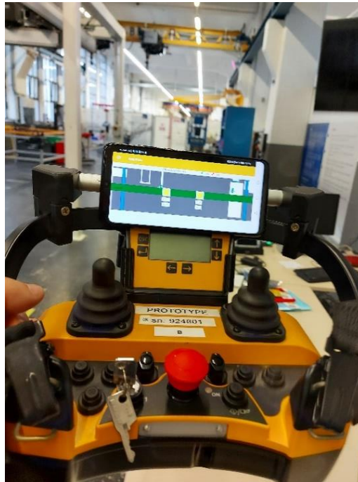
Bild 16: Kransteuerung mit GUI Element
