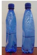
Abb. 19: Kohlenstoffdioxid löst sich in Wasser, wodurch die Flaschen einbeulen
