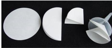
Abb. 30: Faltung eines Rundfilters für die Filtration mit einem Trichter
