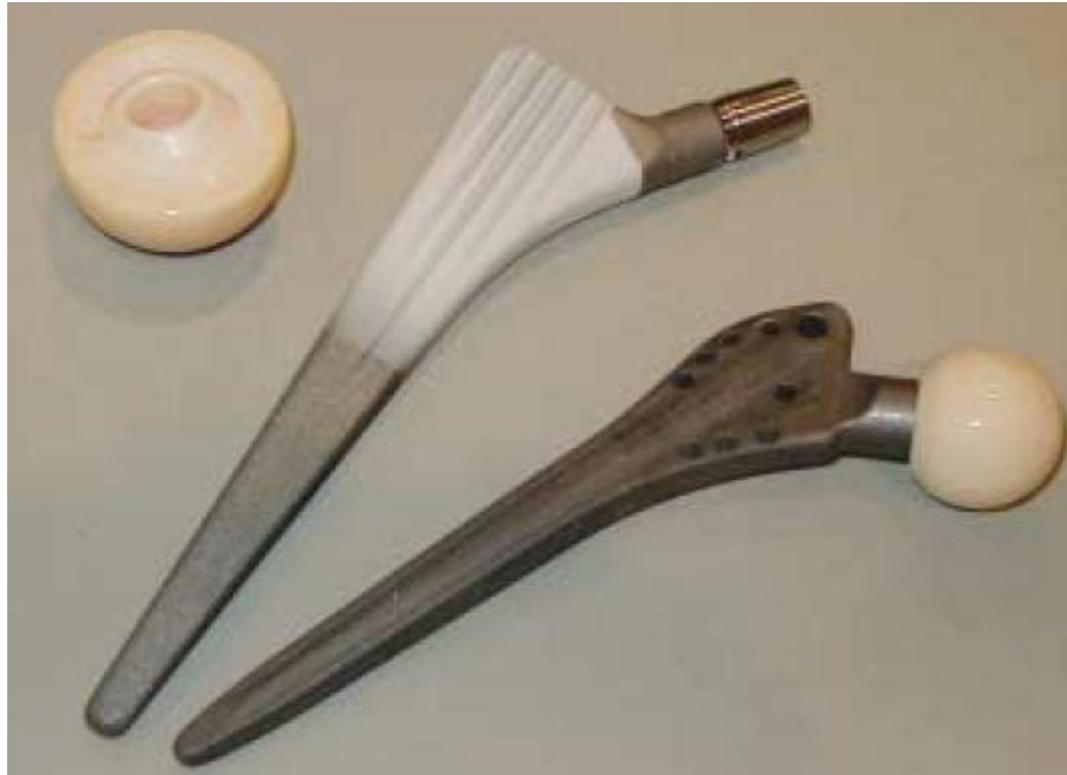
Calciumphosphate in der Hüftendoprothetik: Ein keramisches Kugelgelenk ( $\text{Al}_2\text{O}_3$ ), eine calciumphosphatbeschichtete Endoprothese (zementfreie Endoprothese) und eine unbeschichtete Endoprothese, die im Femurschaft mit PMMA-Knochenzement fixiert wird. PMMA Poly(methylmethacrylat).
