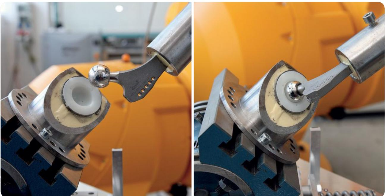
links: So ist die Hüftendoprothese am Roboterarm befestigt. Die Steuerung erfolgt nach einem numerisch-mathematischen Modell; rechts: Die Hüftendoprothese sitzt fest in der Gelenkpfanne. Der Testlauf kann beginnen.
